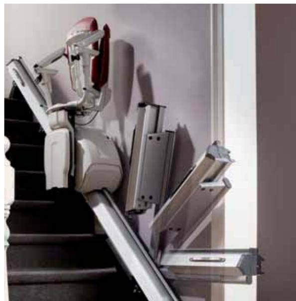
Nel caso in cui ci fosse un ostacolo in fondo alla scala o lo spazio disponibile fosse limitato, potrete decidere di installare una guida pieghevole automatica. Una volta usato, il montascale ritorna in cima alle scale e la sezione inferiore della guida si ripiega, lasciando libero il pianerottolo.
